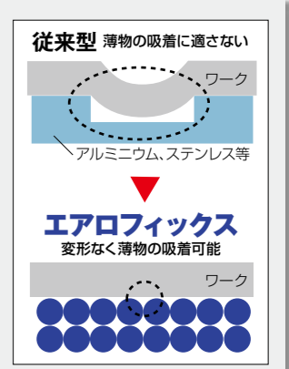
●従来の薄物の吸着に適さない ●アルミニウム、ステンレス等 ●エアロフィックス 変形なく薄物の吸着可能 ●ワーク
