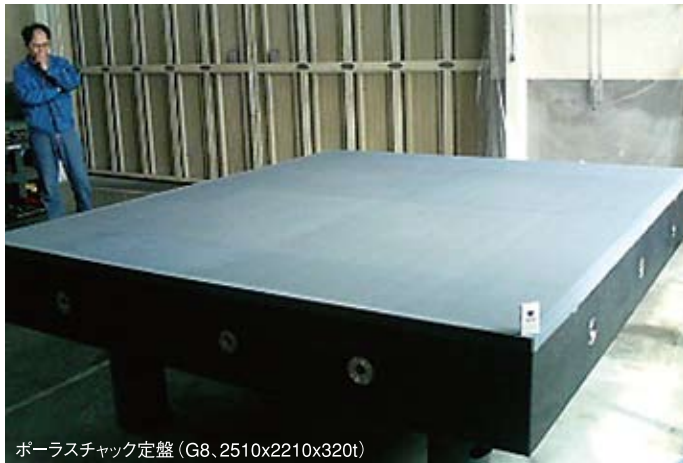
ポラスチャック定盤 (G8, 2510x2210x320t)
